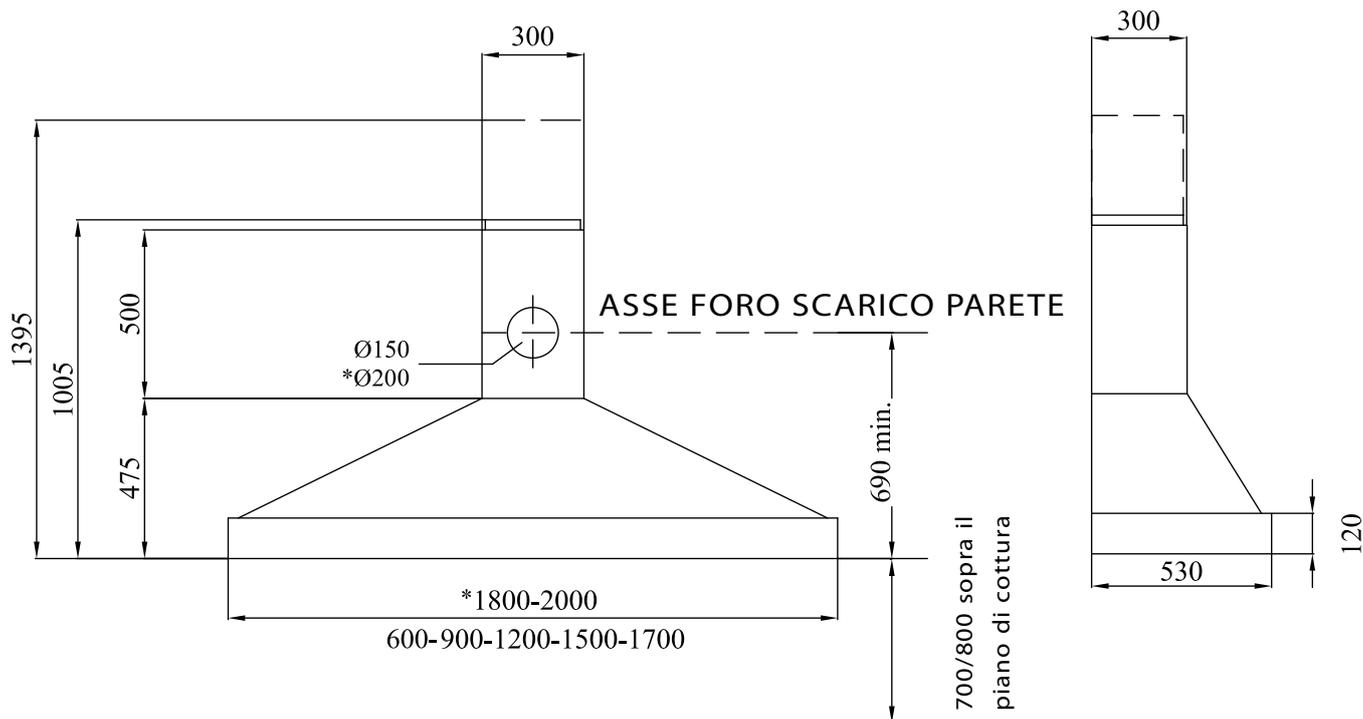
Non collegare la cappa ad uno scarico ridotto rispetto a quello previsto. Rischio di malfunzionamento e surriscaldamento del motore. Nel caso non fosse possibile predisporre lo scarico  $\varnothing$  200 mm (1200 mc/h), ove previsto come standard (KA180-200), si consiglia di richiedere la cappa con motore per scarico  $\varnothing$  150 mm (900 mc/h).
