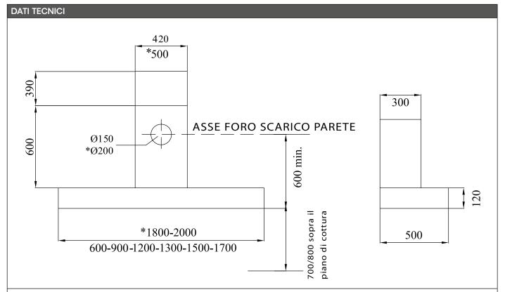
Non collegare la cappa ad uno scarico ridotto rispetto a quello previsto. Rischio di malfunzionamento e surriscaldamento del motore. Nel caso non fosse possibile predisporre lo scarico  $\varnothing$  200 mm (1200 mc/h), ove previsto come standard (KP180-200), si consiglia di richiedere la cappa con motore per scarico  $\varnothing$  150 mm (900 mc/h).
